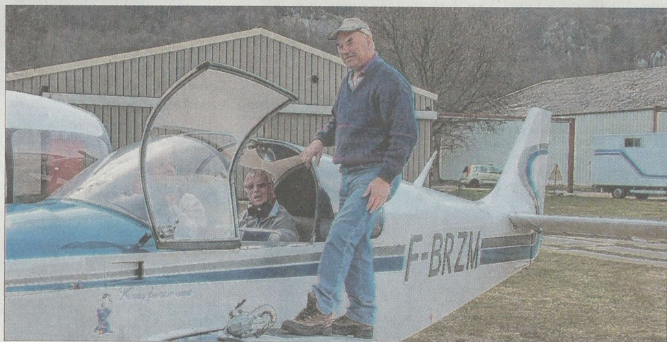
Le Kim Force One pèse environ 500kg. Avant de prendre son décollage, l'avion doit toujours être placé face au vent pour augmenter l'importance de l'aile.
